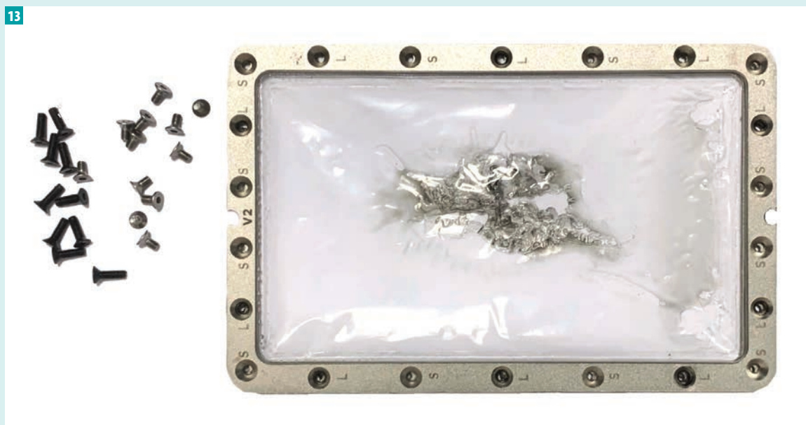
Fot. 13. Wymagana liczba śrubek do wkręcenia w Zortrax InkSpire
