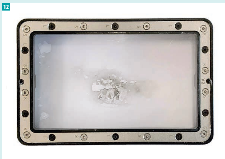
Fot. 12. Uszkodzona folia FEP
