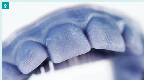
Fot. 9. Wydruk 100 nm bez użycia funkcji wygładzania krawędzi wydruku SprintRay Pixel Toning
