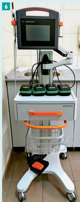
Fot. 6. Laser diodowy Smart M Pro (f. Lasotronix) wykorzystywany w zabiegach stomatologicznych (zdjęcie wykonano dzięki uprzejmości dr. n. med. Rafała Wiencha z Katedry i Zakładu Chorób Błón Śluzowych i Przyzębia SUM)
