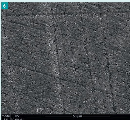
Fot. 6. Dwukrzemian litu po wytrawieniu przez 60 s 5-proc. kwasem fluorowodorowym – zaobserwowano więcej odsłoniętej fazy krystalicznej, co prowadzi do głębszego wytrawiania
